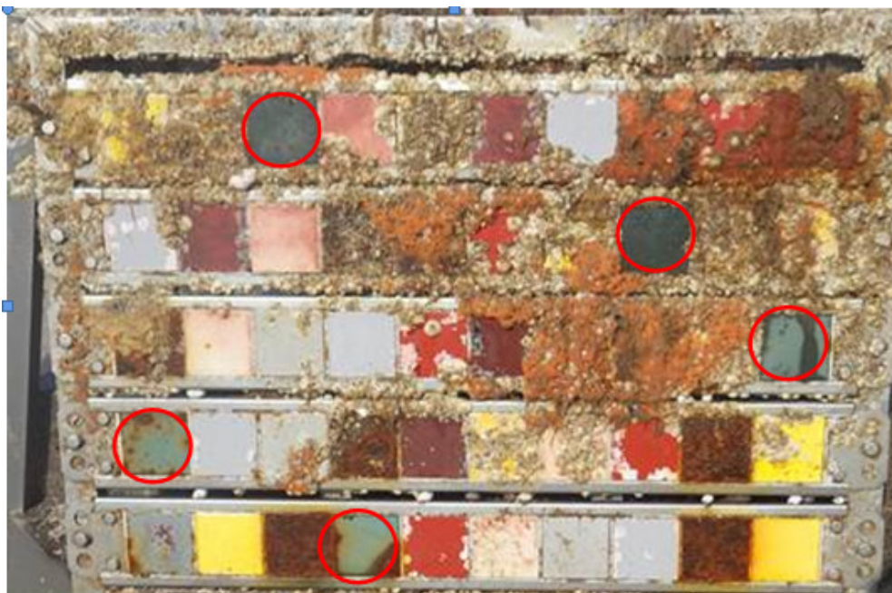
Figura 3: Imagen del conjunto completo tras su recuperación en 2017, después de 60 meses de exposición in situ.
