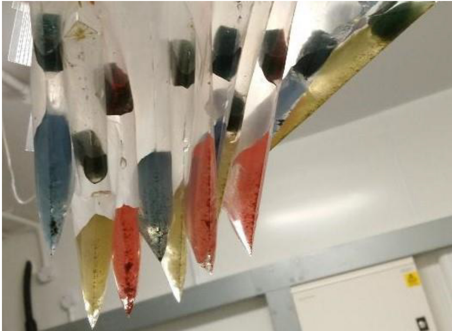
Figura 4: Bolsas con cierre hermético y almohadillas de fregado tras exprimir los recubrimientos absorbidos durante la prueba de limpieza.
