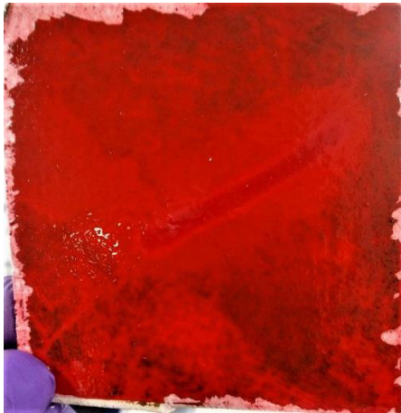
Figura 5: Rastro de la limpieza por presión en un panel de prueba recubierto con Micron 350. El contraste de la imagen ha sido mejorado para mayor claridad.
