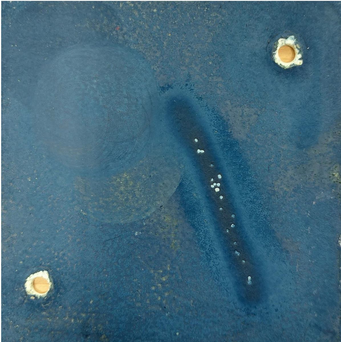
Figura 16: Imagen representativa en primer plano de un panel Cruiser 250 tras tres limpiezas simuladas (fregado y lavado a presión), limpieza final de bioincrustaciones y secado. Se observa una marca redonda de fregado estandarizado en la parte superior izquierda del panel y una marca lineal de lavado a presión estandarizado desde el centro hacia la parte inferior derecha. Además, la capa fue eliminada lo suficiente con el lavado a presión como para que el sustrato empezara a ser visible tras el tercer ciclo (manchas blancas en la zona lavada a presión).
