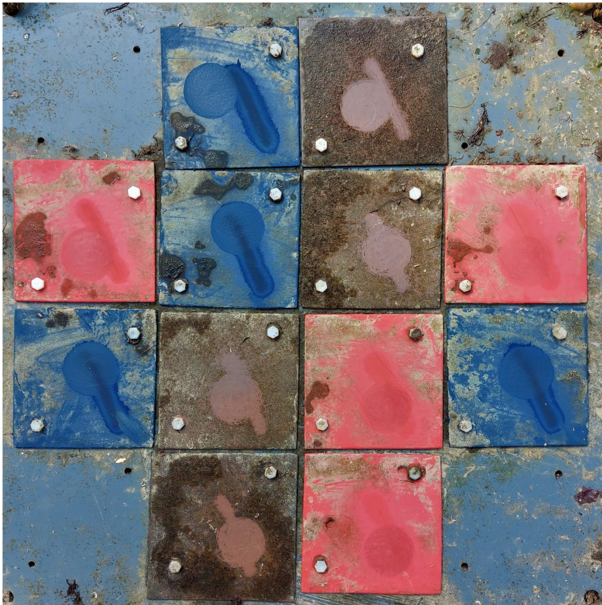
Figura 9: Imagen representativa de una lámina base y los paneles tras el fregado estandarizado, lavado a presión y reensamblaje después de las pruebas. Los paneles azules corresponden a Cruiser 250, los marrones/cobrizos a Coppercoat y los rojos a Micron 350. Se observan marcas circulares de fregado y marcas lineales del lavado a presión. Además, en todos los casos, los tratamientos fueron lo suficientemente eficaces para eliminar toda la suciedad de las áreas tratadas.
